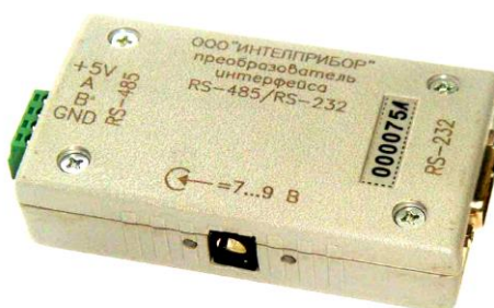
Рис. 5.1 Внешний вид преобразователя интерфейса RS-485/RS-232
