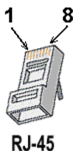
Рисунок 12.2 Нумерация выводов вилки RJ-45
