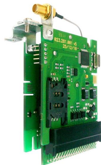
Рисунок 13.2 Внешний вид платы П4Р с установленной ПР ПСМ-300
