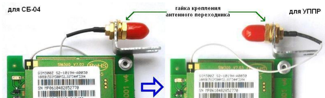
Рисунок 17.10. Изменение направления крепления антенного переходника.
