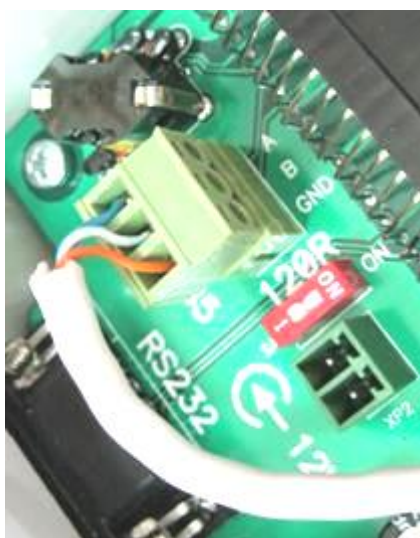
Рисунок 17.5. Подключение к УППР линии связи интерфейса RS-485
