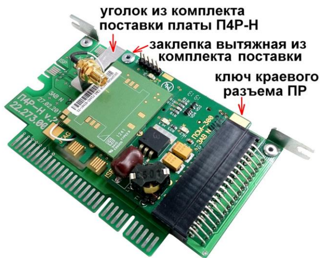
Рисунок 14.2 Внешний вид платы П4Р-Н с установленной ПР ПСМ-300
