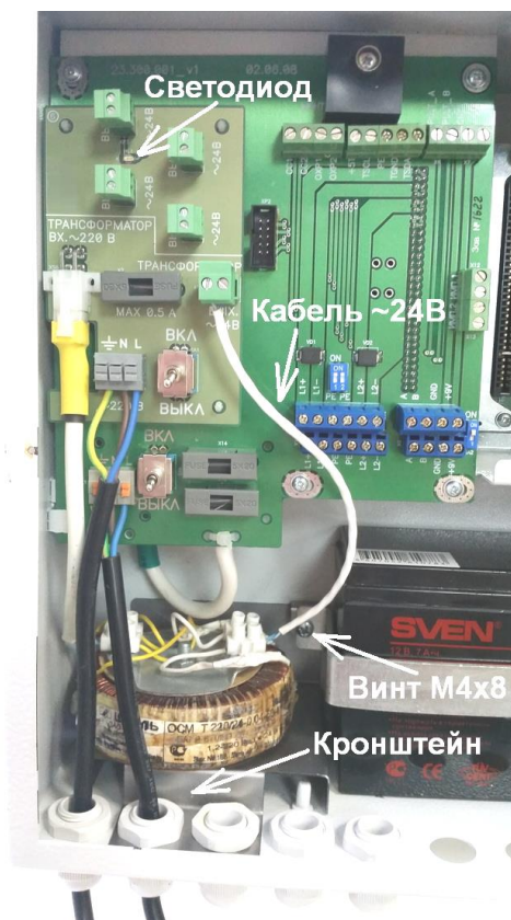
Рисунок 10.7. Стойки на плате подключения СБ. Рисунок 10.8. Монтаж ИППР-Т в СБ МКТС.
